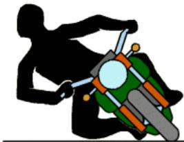
Beim Hängen schließlich ist der Körper des Fahrers noch weiter geneigt, als die Maschine. Der Fahrer "hängt" förmlich an der Kurveninnenseite.
